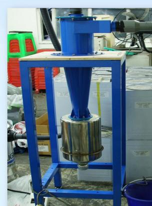
圖6 旋風分離器及收集槽
